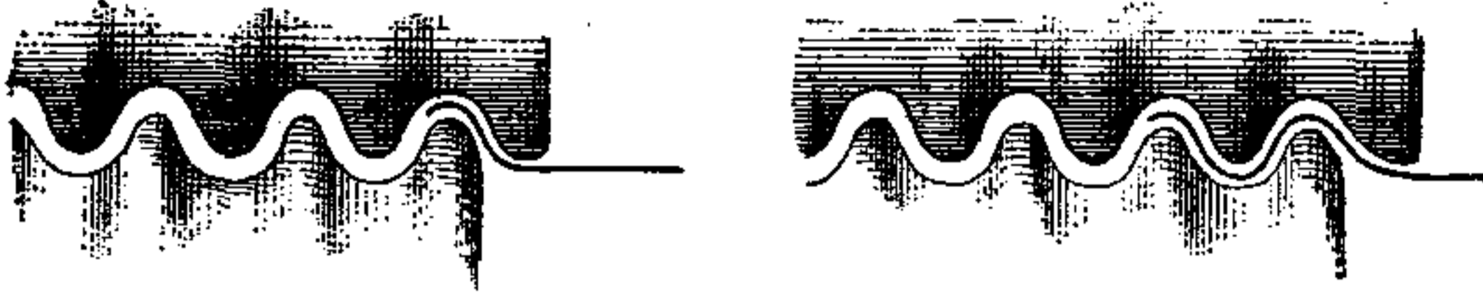
801 и 802. Прокатка волнистой трубы.
